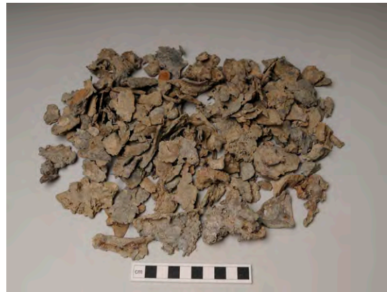
Figur 35. Smältor av blylegering, fyndnr 21, sannolikt av samma typ av lödtenn som i barrarna i figur 34. Foto: Lotta Fernstål.
