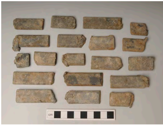
Figur 34. Använda barrar av Televerkets kabellödtenn, fyndnr 15. Foto: Lotta Fernstål.
