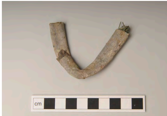
Figur 36. Kabel med koppartrådar och blyhölje, fyndnr 14. Foto: Lotta Fernstål.
